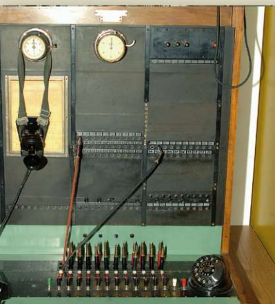
Als das Telefon laufen lernte: Eine der ersten Handvermittlungsanlagen, die noch aus dem Kaiserreich um 1885 stammt (Fotos links).
