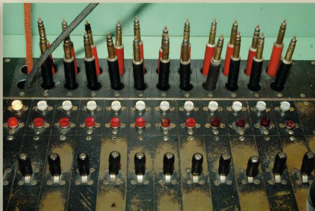
Als das Telefon laufen lernte: Eine der ersten Handvermittlungsanlagen, die noch aus dem Kaiserreich um 1885 stammt (Fotos links).
